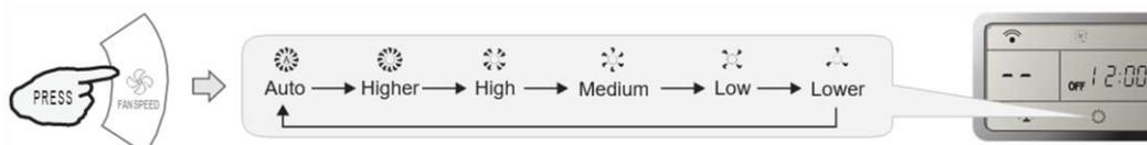
**În modul „FAN ONLY” („DOAR VENTILATOR”), setarea „AUTO” pentru viteză nu este disponibilă. În modul „DRY” („DEZUMIDIFICARE”), viteza ventilatorului este setată automat la „AUTO”, butonul „FAN”(VENTILATOR) nefiind funcțional în acest caz.**
