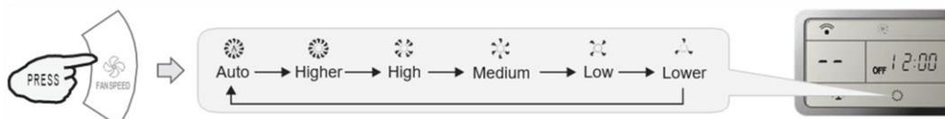
A "FAN ONLY" (CSAK VENTILÁTOR) üzemmódban az "AUTO" sebességbeállítás nem áll rendelkezésre. "DRY" üzemmódban a ventilátor sebessége automatikusan "AUTO" értékre áll, a "FAN" (VENTILÁTOR) gomb ebben az esetben nem működik.
