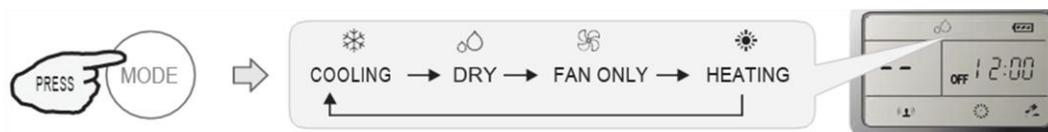
A fűtés **NEM** áll rendelkezésre azokban a légkondicionáló készülékekben, amelyek kizárólag hűtési funkcióval vannak ellátva.
