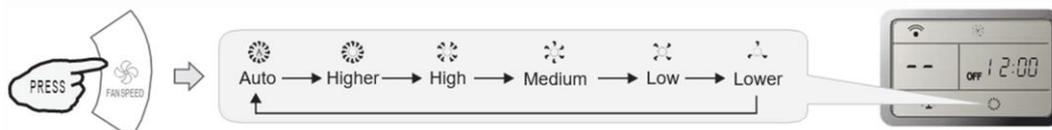
В режим „FAN ONLY“ („САМО ВЕНТИЛАТОР“), настройката „AUTO“ за скорост не е достъпна. В режим „DRY“ („ИЗСУШАВАНЕ“), скоростта на вентилатора е настроена автоматично на „AUTO“, като бутонът „FAN“ (ВЕНТИЛАТОР) не е функционален в този случай.
