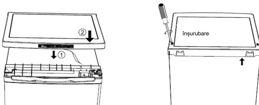
11. Cu ușa închisă, verificați dacă ușa este aliniată orizontal și vertical și dacă garniturile se închid pe toate laturile înainte de a strânge, la final, balamaua inferioară. Reglați din nou picioarele de nivelare conform necesităților.
