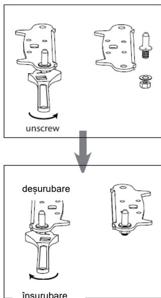
6. Puneți la loc consola și tija balamalei inferioare. Puneți la loc ambele picioare de reglare.
