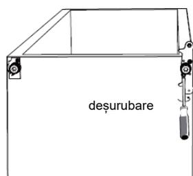
5. Deșurubați și scoateți tija balamalei inferioare, întoarceți consola invers și remontați-o.
