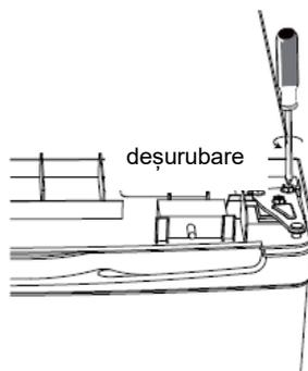
4. Scoateți șuruburile și balamaua inferioară. Apoi scoateți picioarele reglabile de pe ambele părți.
