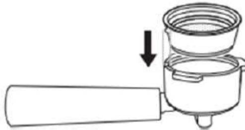
2. Rotirajte filter prema lijevoj strani ili prema desnoj da biste ga pričvrstili. Tako će filter biti montiran na odgovarajući način u držač filtera.
