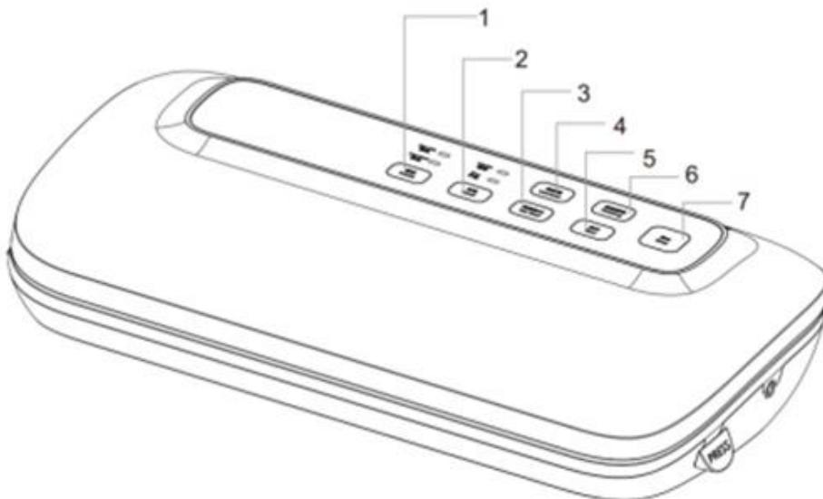
1. „**Mode**” gomb: Két üzemmód („Normál” és „Kíméletes”) állítható be. Az alapértelmezett üzemmód a „Normál”. Ha az étel morzsálódik, akkor ezt a gombot megnyomva a gépet „Kíméletes” vákuumozási üzemmódra kapcsolhatja. A „Seal” gomb megnyomásával bármikor kézzel szabályozhatja a vákuumozás mértékét. Az élelmiszer automatikusan lezárásra kerül. Megjegyzés: ha a tápellátás megszakad, ez a beállítás visszaáll az alapértelmezett üzemmódra.
