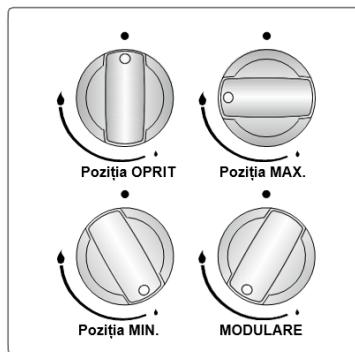
După aprindere, verificați vizual flăcările. Dacă vedete o flacără cu vîrf galben, ridicată sau instabilă, opriți debitul de gaz, apoi verificați ansamblul capacelor și coroanelor arzătoarelor după ce s-au răcit. Asigurați-vă că nu există lichid în capacacele arzătorului. Dacă flăcările arzătorului se opresc în mod accidental, opriți arzătoarele, aerisiți bucătăria cu aer proaspăt și nu încercați să reaprindeți timp de cel puțin 90 de secunde.
