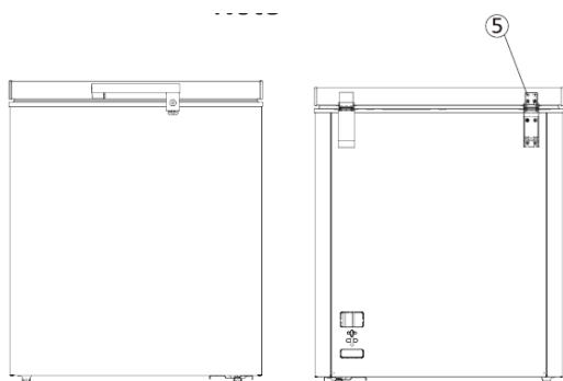
**ЗАБЕЛЕЖКА:** Ако пръстенът на ключалката не може да я задържи при монтажа на дръжката, развийте винтовете с кръгла глава (5) на гърба на вратата и регулирайте положението на врата по-нагоре или по-надолу. След това завийте винтовете, за да закрепите дръжката.
