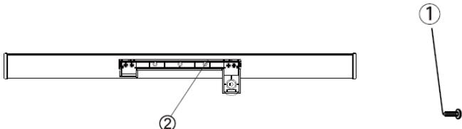
1. Извадете винтовете (1) от корпуса на фризера и вратата с помощта на инструмент, общо 7 на брой, и извадете основата на дръжката с ключалка (2), капака на дръжката (3) и пръстена на ключалката (4)
