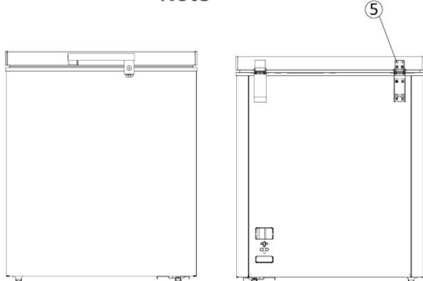
**NOTĂ:** Dacă inelul de blocare nu a ținut zăvorul la instalarea mânerului, vă rugăm să desurubați șuruburile cap rotund (5) de pe partea din spate a ușii și să reglați poziția ușii în sus sau în jos. Apoi însurubați la loc pentru fixarea mânerului.
